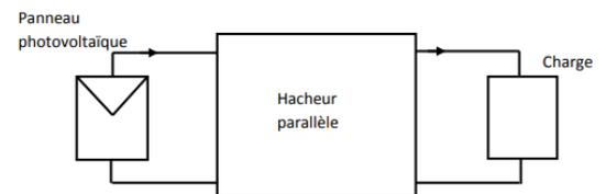
L'adaptation entre la source et la charge est réalisée par la variation du rapport cyclique  $\alpha$  du hacheur de la figure suivante, qui fonctionne en conduction continue.
